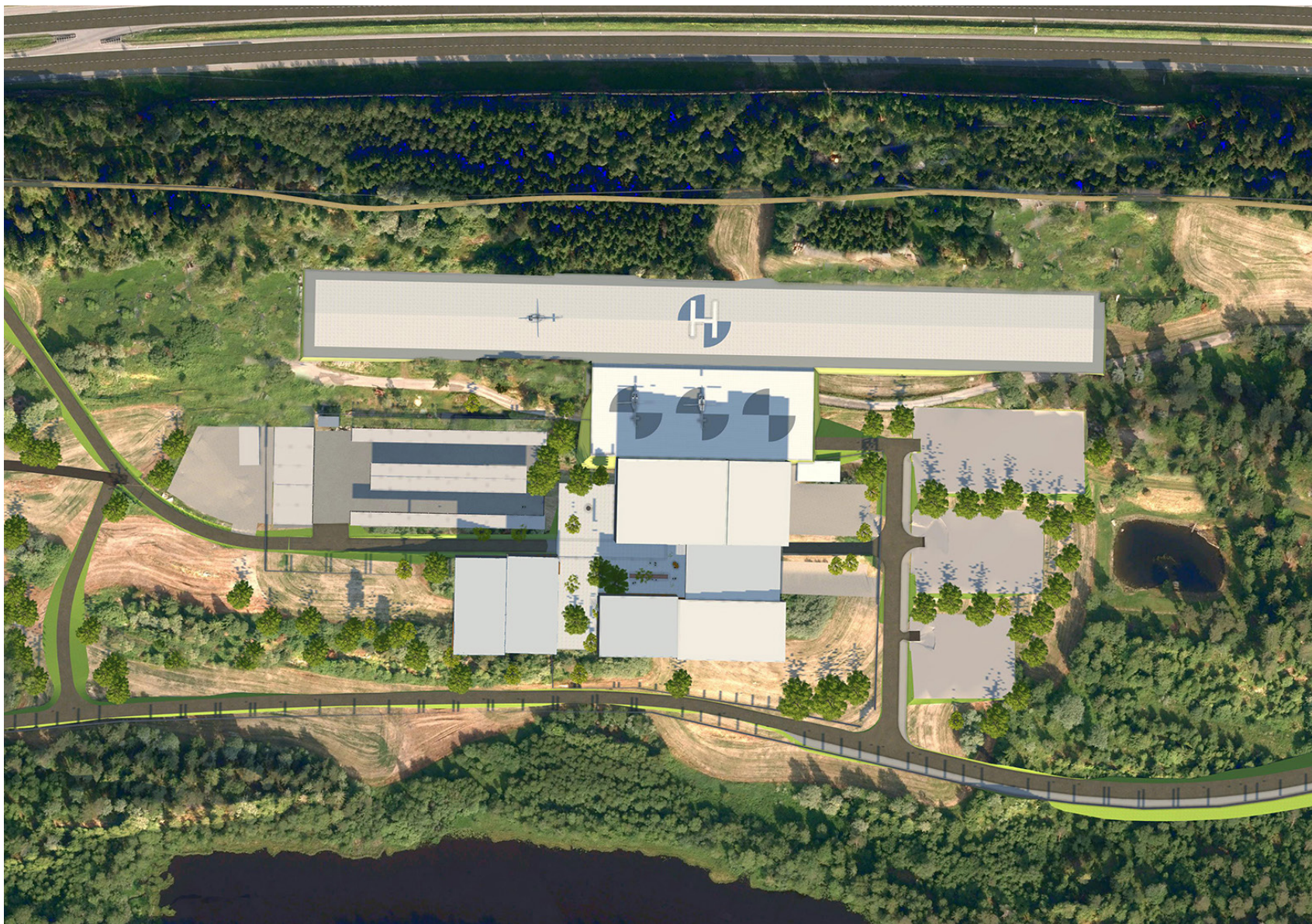
Figur 5: Hovedbygg og helikopterplass. (Nord er til venstre på figuren). Helikopterplassen plasseres på en høytliggende del på tomten, parallelt med E6. I det fallende terrenget ned mot Snipetjern planlegges hangarer og hovedbygg plassert. Ansattparkering vises sør (til høyre) for hovedbygget. Sør for parkeringen sees eksisterende gårdsdam på Taraldrud gård.
