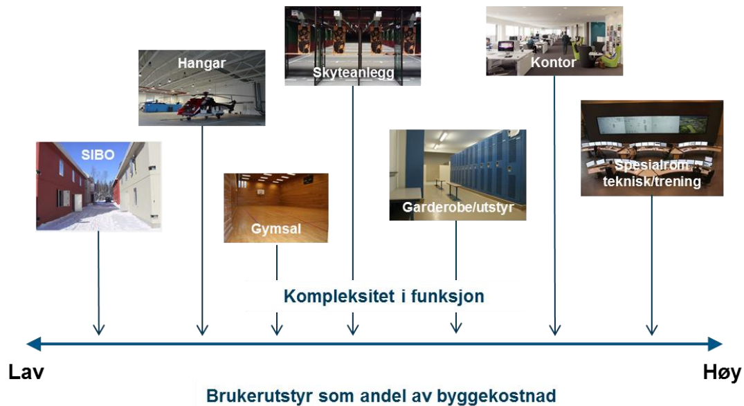
Figur 3-2: Kostnader til brukerutstyr som en andel av byggekostnaden. Brukerutstyrsandelen avhenger av funksjonenes kompleksitet.
